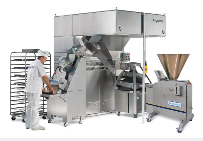
A partir de bollos armados en una línea semiautomática constituida por una amasadora, una divisora, una bollera y un descansador, el equipo modular Véneto Pizzas permite elaborar hasta 1200 discos para pizzas por hora de excelente calidad y presentación.
