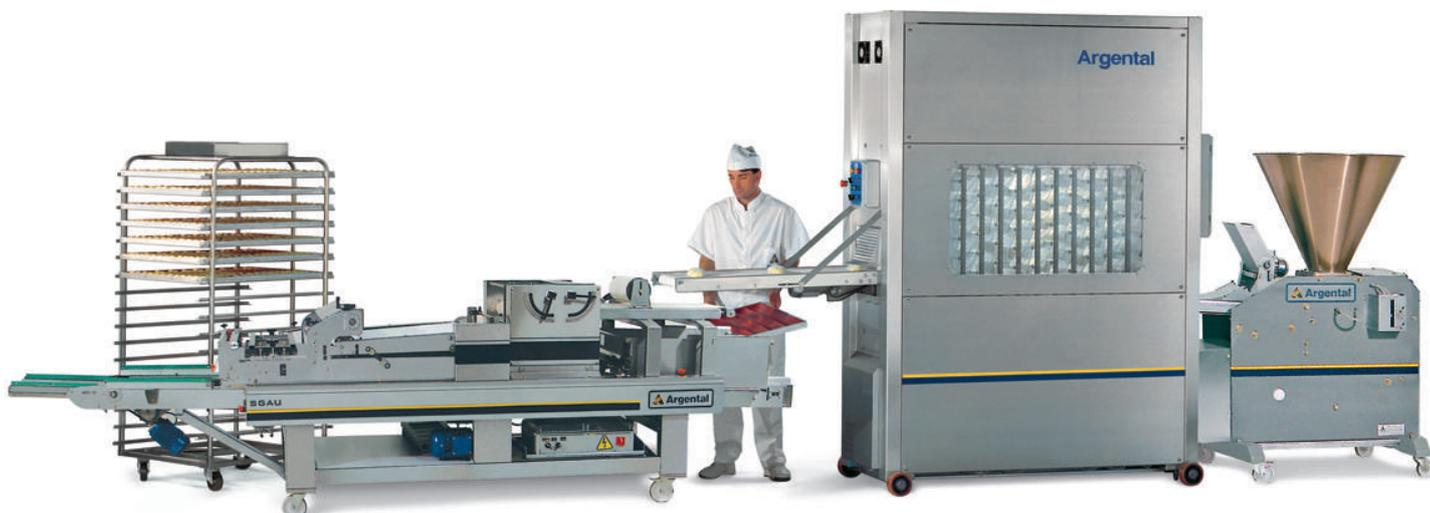
El equipo Galo Pro 2000 de Argental es un sistema modular y automatizado que permite la elaboración continua de pan francés, baguettes y una gran variedad de productos de panificación. Por sus dimensiones es ideal para pequeñas y medianas panificadoras sosteniendo ritmos de fabricación de entre 850 y hasta 1500 barras de pan/hora.
